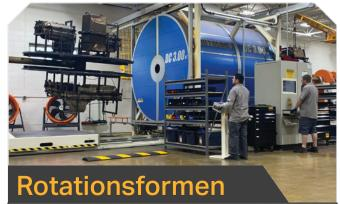
Komplexe Formen, die unser "Tank-in-Tank"-Design ermöglichen, werden qualitativ am besten mit unseren hauseigenen Maschinen erreicht. Wir besitzen mehrere Rotationsformmaschinen mit zwei Stationen, die es uns ermöglichen, perfekt passende Bauteile aus Rohkunststoff herzustellen.
